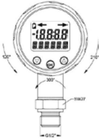
G1/2" flush DIN 3852 1 bar ≤ PN ≤ 600 bar
